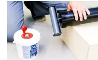
2. Düsenhalter abschrauben und Schlauchbeutel entfernen.
