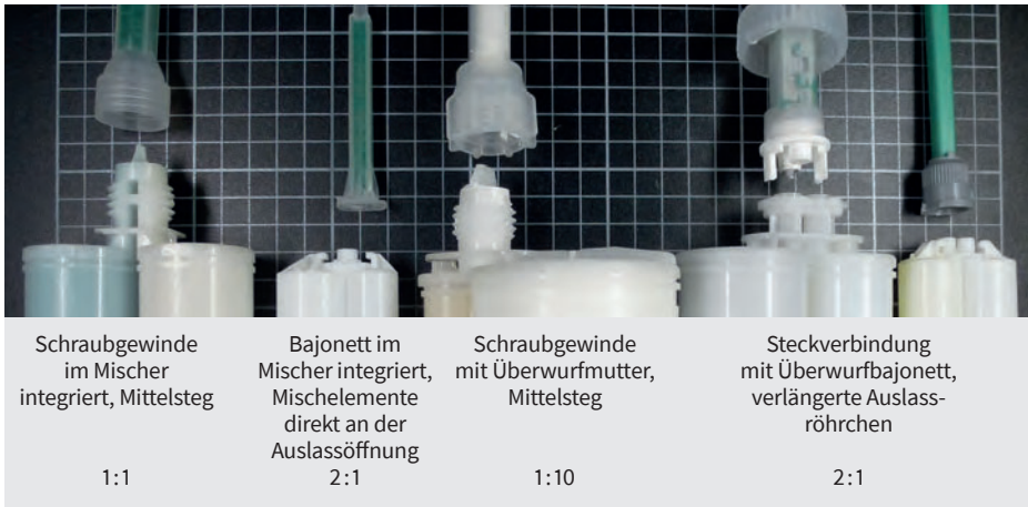
Abb. 2: Auswahl der wichtigsten Schnittstellen zwischen Kartusche und Mischer
