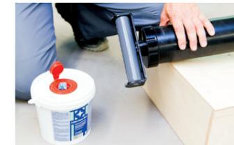
2. Düsenhalter abschrauben und Schlauchbeutel entfernen.
