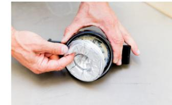
3. Entfernen der ATD Düse durch das Lösen der beiden Arretierungsschrauben an der Oberseite der Halterung.
