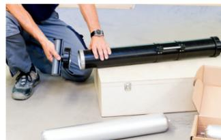
4. Klebstoffschlauchbeutel langsam in den Zylinder gleiten lassen, bis er vollständig im Gehäuse ist.
