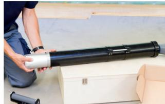
5. Auslöser betätigen bis der Siegelring aus der Maschine herausragt.
