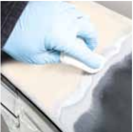
Optionales Auftragen von BONDERITE M-NT 1455-W auf blanke Metalloberflächen. Ca. 5 Min. ablüften
