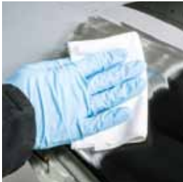
Flächen mit TEROSON VR 20 reinigen und vorbereiten
