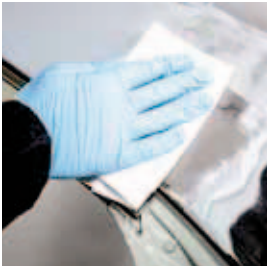
Oberfläche mit TEROSON VR 20 und einem fussel-freien Tuch reinigen und vorbereiten
