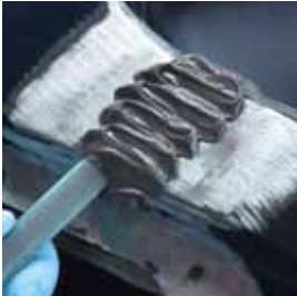
Auftragen von TEROSON EP 5010 TR
