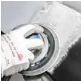
Schleifen mit Schleifmaschine möglich, um die gewünschte Oberflächen-güte zu erzielen
