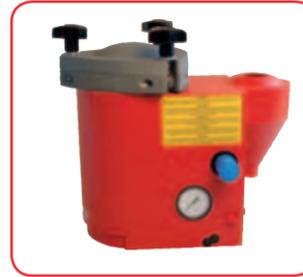
Dieses Gerät ist einfach zu bedienen. Der Bediener setzt die Flasche in den Tank ein und zieht die drei Schrauben am Deckel fest. Anschließend wird der Druckbehälter mit Druckluft beaufschlagt. Dabei wird der für die optimale Mengenregelung erforderliche Druck eingestellt. Das Produkt wird über ein manuell betätigtes Handdosierventil aufgetragen. Durch Verdrehen der Stellschraube am Handtaster wird die Dosierrate eingestellt.
