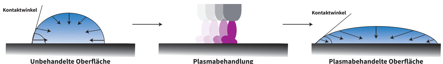
Abb. 2: Verhalten einer Flüssigkeit auf einem schwer benetzbaren Material (hoher Kontaktwinkel zwischen Tropfen und Oberfläche). Die Plasmabehandlung verbessert die Benetzbarkeit des Materials (der Tropfen zerläuft, der Kontaktwinkel wird reduziert).
