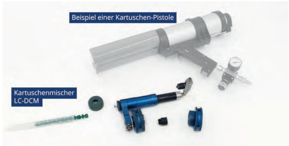
Abb. 2: Der Mischeraufsatz wird an der Kartuschenpresse befestigt und bildet mit ihm eine funktionelle Einheit. Durch den austauschbaren Adapter lässt sich der LC-DCM für verschiedene Kartuschen nutzen.
