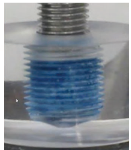
Abb. 1: Klebstoffapplikation im Sacklochgewinde: links auf die Schraube dosiert, rechts in das Sackloch [Quelle: Dietrich, Technische Hochschule Ulm]
