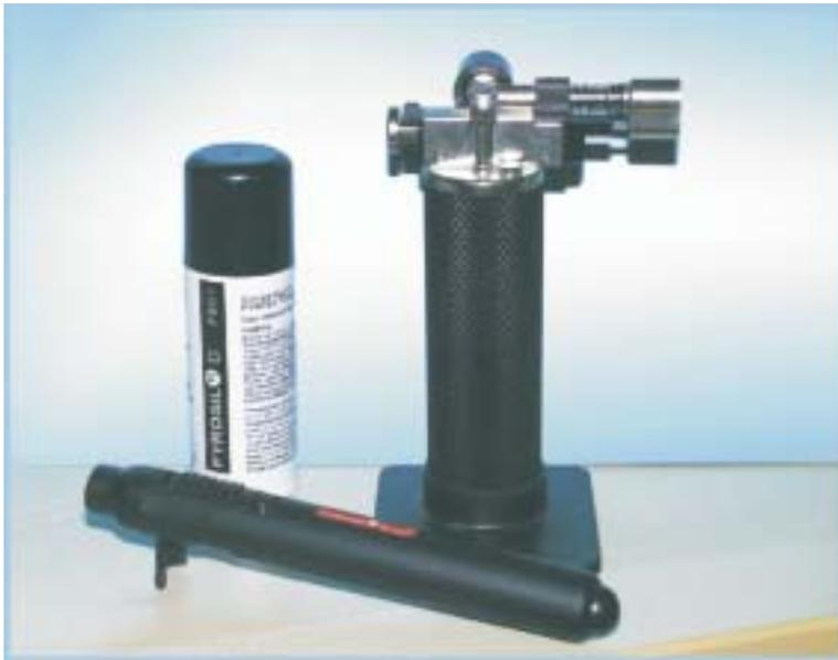
Die PYROSIL<sup>®</sup> Flammenbeschichtungsgeräte FB 07 und FB 25 sind Oberflächenaktivierungsgeräte, die nach dem Prinzip der Flammenpyrolyse arbeiten. Eine nur wenige Nanometer dünne, jedoch sehr dichte und festhaftende Siliciumdioxidschicht auf Metall, Glas, Keramik sowie Kunststoffen wird erzeugt. Das FB 25 und das FB 07 werden zur Handbeflammung und zur Silikatisierung von Oberflächen (PYROSIL<sup>®</sup>-Coating) kleinerer und mittlerer Teile eingesetzt.
