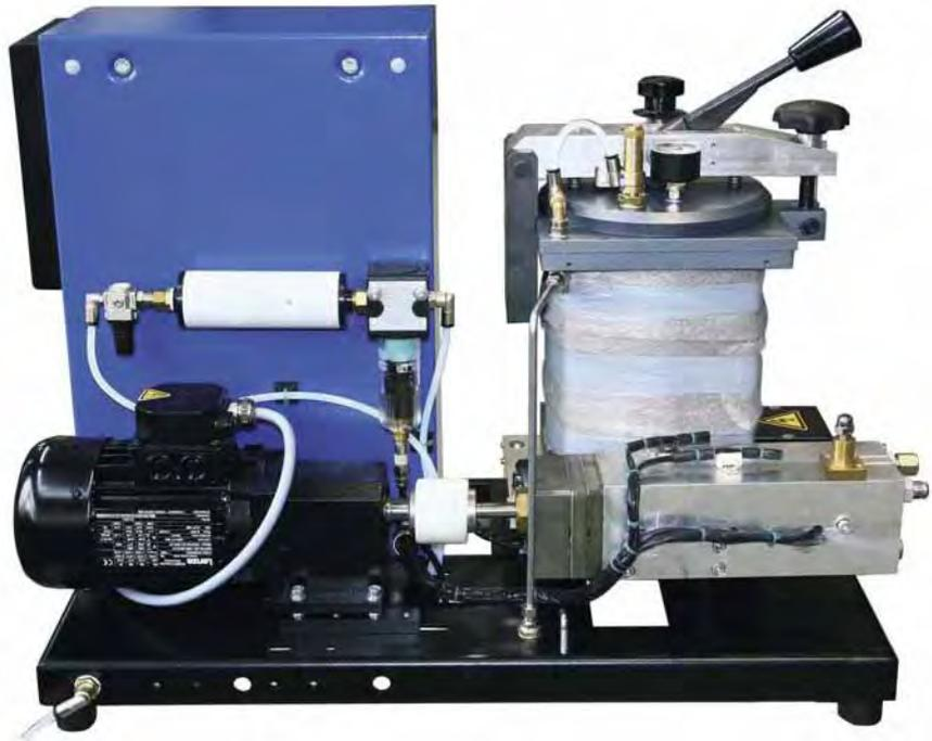
Ein Nachfüllen von **PUR /POR Schmelzklebstoff** ist ohne Produktionsunterbrechung möglich, da die Tankanlagen über einen Progressiv Schmelzbereich verfügen. Es steht jederzeit eine homogene flüssige Schmelzklebstoffmenge zur Verfügung. In den Anlagen können alle handelsüblichen Gebindeformen von 2,0 bis 18,0 kg je nach Tankanlagen Ausführung verarbeitet werden.
