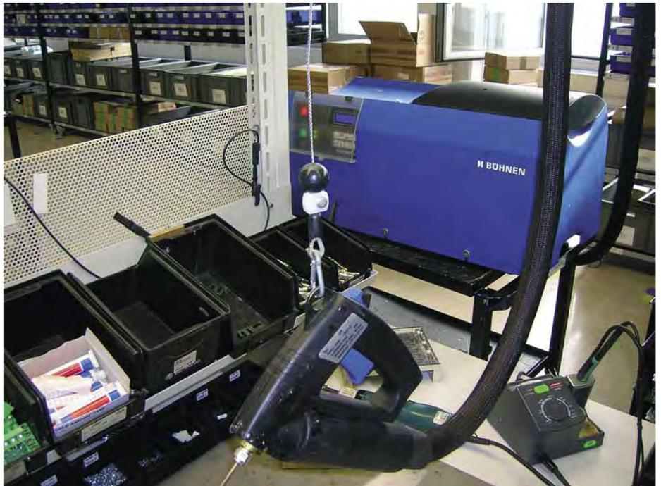
Die Steuerung des Gerätes hat ein leicht ablesbares Display mit klarer Funktionszuordnung. Integriert in die Temperaturregelung ist eine Wochenuhr, eine Temperaturabsenkung manuell oder programmierbar und eine Umschaltung auf NI 120 Temperaturfühler.
