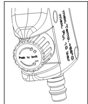
Para garantir uma descarga contínua, a pressão de trabalho deverá ser ajustada correctamente antes do início da descarga.
